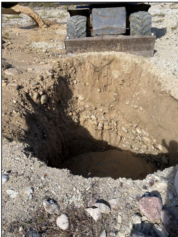
Foto 5. Kaevand K03, kus on näha diagonaalne kruusakiht ja avatud pinnasevesi.
